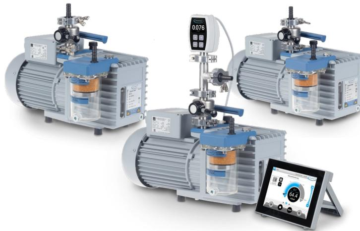
Die Drehschieberpumpen RZ 2.5 und RZ 6 mit Zubehör sind nützliche Praxis-Pakete mit Auspuff-Filter FO für die Ölnebelabscheidung (mit integriertem Sicherheitsüberdruckventil) und manuellem Saugleitungsventil, um die Pumpe zuverlässig warmlaufen zu lassen. Auch ein Paket mit zusätzlichem Feinvakuum-Messgerät VACUU-VIEW extended ist erhältlich.
