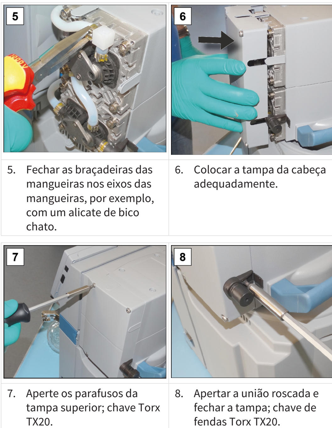
Fig. 8 descrição opcional, apenas válida para a cabeça da bomba com lastro de gás GB
