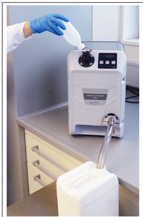
Arranjo exemplar para enxaguação da bomba de vácuo
