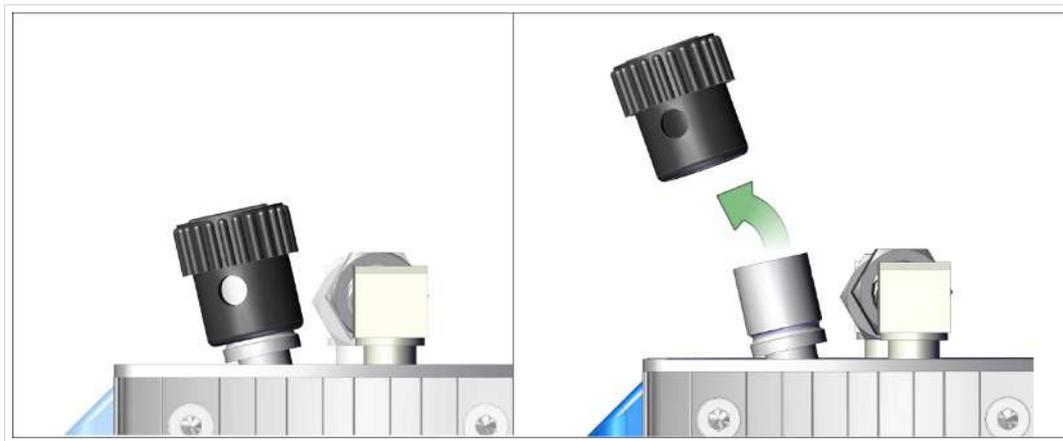
⇒ Rimuovere il coperchio nero per il zavorratore di gas e collegare al suo posto un adattatore per zavorratore di gas.
