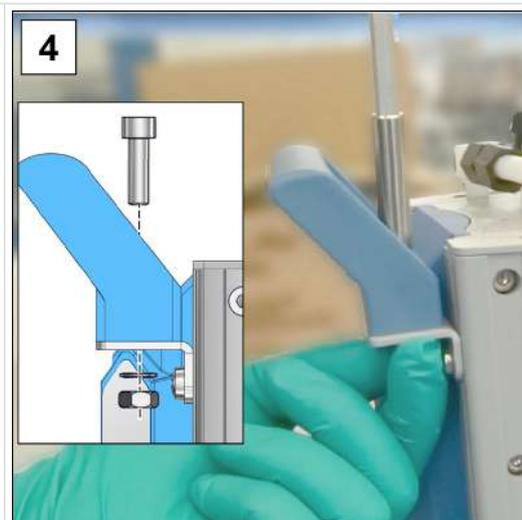
4. Fissare l'impugnatura; chiave a brugola Dim. 5.
