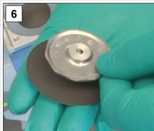
6. Assemblare l'unità della membrana e fare attenzione al corretto posizionamento sul quadrato.
