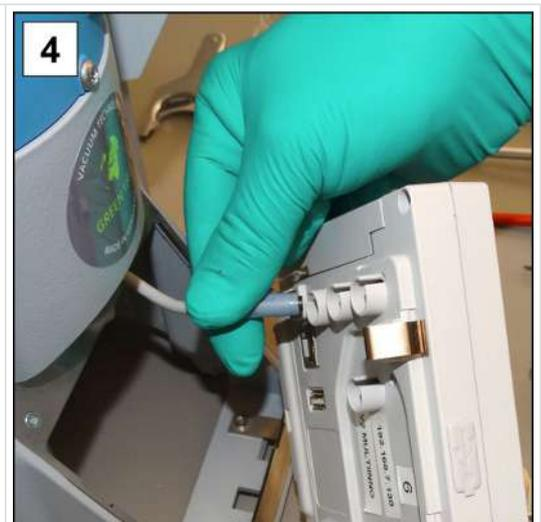
4. Ruotare correttamente la stazione di pompaggio e collegare i cablaggi: VACUU·BUS, spina.
