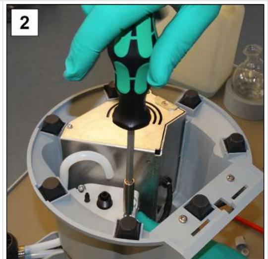
2. Inserire le viti di fissaggio e stringerle bene manualmente; vite a brugola Dim. 3
