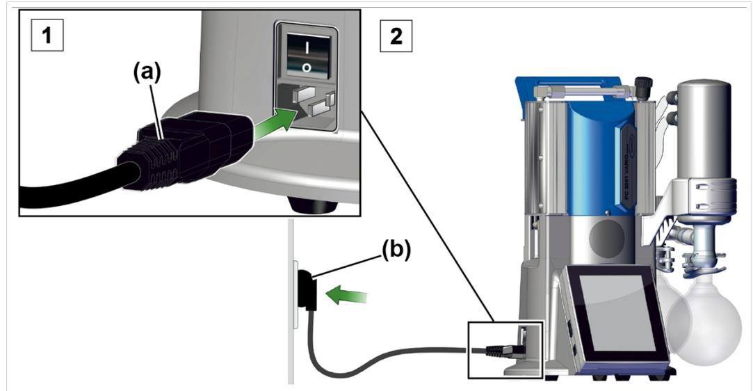
1. Inserire la boccia (a) del cavo di rete nel collegamento di rete della pompa a vuoto.
