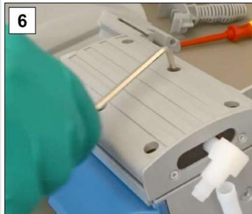
6. Applicare il coperchio dell'alloggiamento in piano e avvitare i collegamenti a vite; chiave a brugola Dim. 4, coppia di serraggio, 6 Nm.
