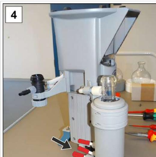
4. Chiudere i raccordi ondolati per flessibile del radiatore e posizionare la stazione di pompaggio con attenzione sulla testata.
