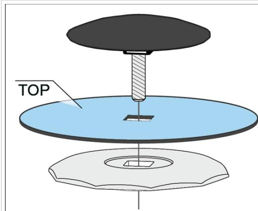
5. Disassemblare l'unità e prendere una nuova membrana; set di guarnizioni MD 1C.
