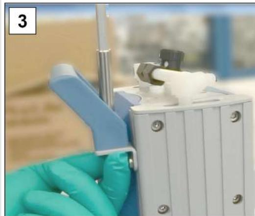
3. Allentare il collegamento a vite dell'impugnatura; chiave a brugola Dim. 5.
