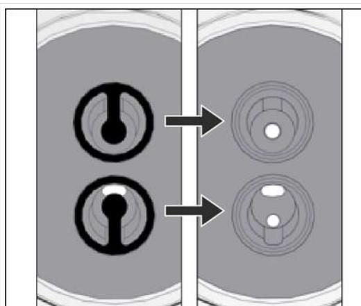
Vista dall'alto in sezione: posizione corretta delle valvole.
