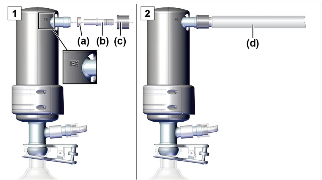
1. Utilizzare l'anello di tenuta in gomma **(a)**, il raccordo ondulato per flessibili **(b)** e il dado di raccordo **(c)** come indicato e avvitarlo tutto questo sull'attacco.
