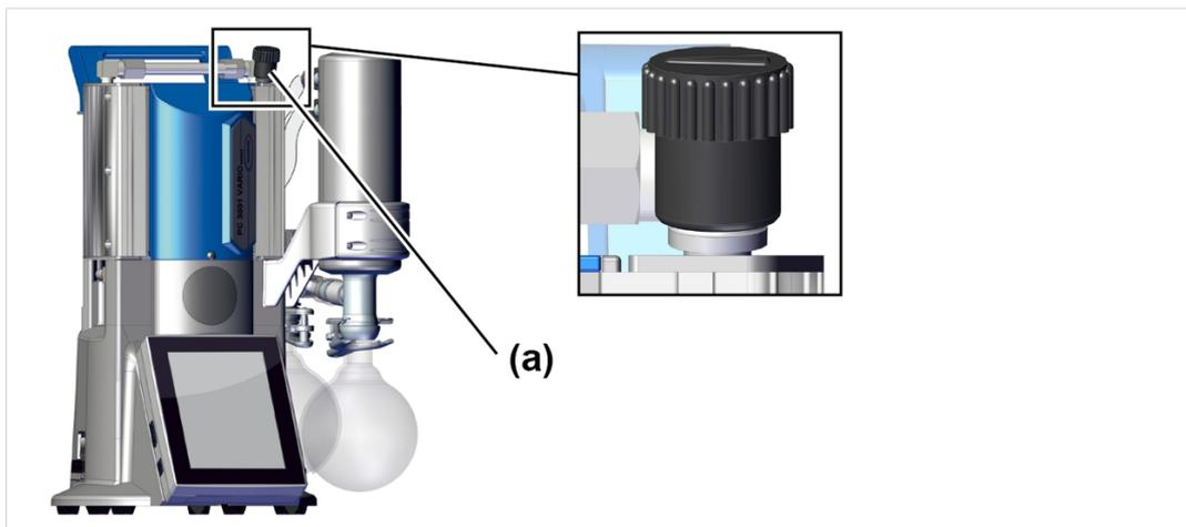
Qualora si debba utilizzare aria ambientale come zavorratore di gas, non occorre collegare nulla sulla stazione di pompaggio; in merito alla valvola per zavorratore di gas **(a)**, vedere anche il capitolo: → **Funzionamento con zavorratore di gas sulla pagina 49**
