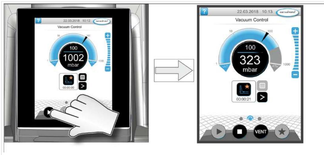
9 Il tasto VENT viene visualizzato solo se è collegata o attiva una valvola di ventilazione.
