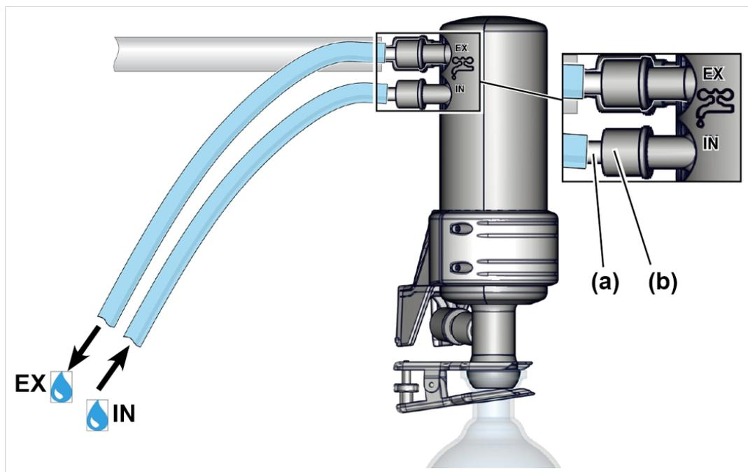
1. Fissare i due raccordi ondulati per flessibili **(a)** sul condensatore con i dadi di raccordo **(b)** nel modo indicato.
