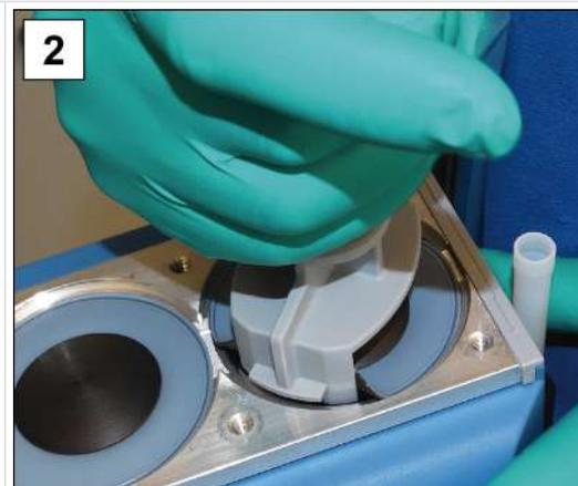
2. Applicare con attenzione la chiave per membrana sul disco di supporto della membrana.
