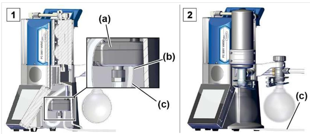
1. Rovesciare leggermente su un lato la stazione di pompaggio e inserire il flessibile (c) sull'attacco della valvola di ventilazione (b).
