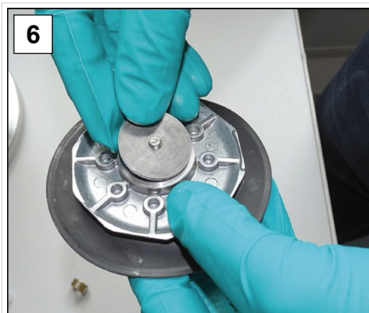
6. Anbring alle afstandskiver på gevindstiften.
