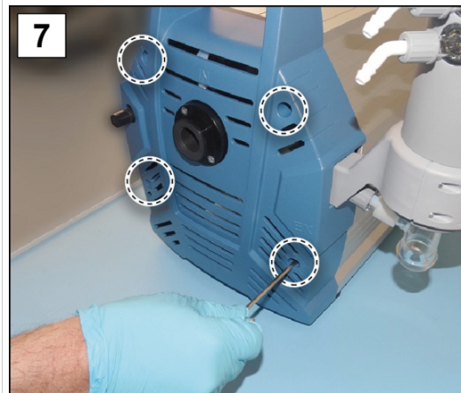
7. Tag de 4 skruer ud af den forreste husdel; unbrakonøgle str. 4.
