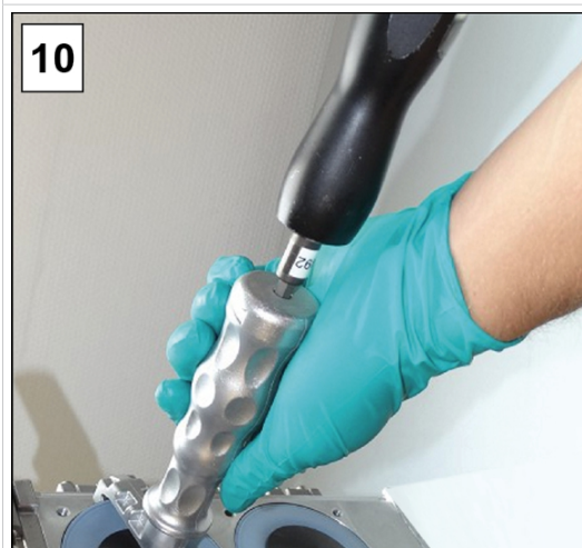
8. Hold fast i afstandskiverne, og anbring forsigtigt alle komponenter på plejlstangens gevind.
