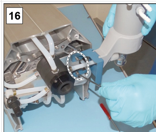
16. Sæt de 2 skrue for EK-holderen i; unbrakonøgle str. 4.
