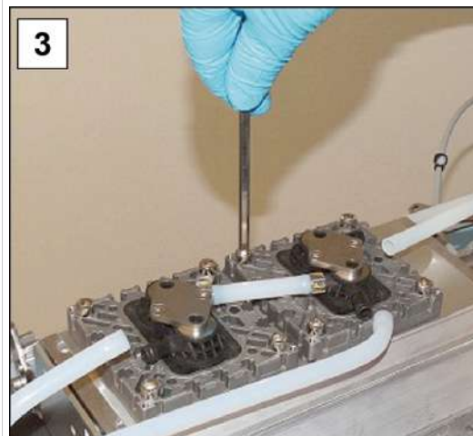
3. Skru unbrakoskruerne ud af hovedafdækningerne. Unbrakonøgle str. 5.
