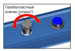
При работе с **конденсируемыми парами** (водяным паром, растворителями и т. д.):
