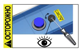
Настройка диапазона напряжения на переключателе напряжения:
