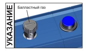
При подаче конденсируемых паров необходимо эксплуатировать насос (MZ 1C) с балластным газом, чтобы уменьшить конденсацию перекачиваемых веществ (водяного пара, растворителей и т. д.) в насосе.
