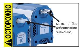
• Соблюдать максимально допустимое давление на входе и выходе, а также максимально допустимую разность давлений между входом и выходом.
