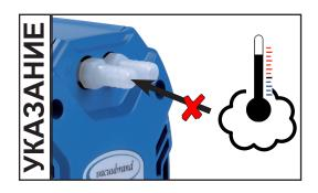
Не допускать сильного притока тепла (например, под действием горячих технологических газов). Допустимый диапазон температур см. в разделе «Технические характеристики / температура газа на входе».
