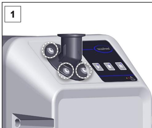
1. Открутить 4 винта на впускном фланце; звездообразная отвертка TX25. Обратить внимание на положение подкладных шайб.
