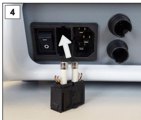
4. Установить держатель предохранителя на цоколь предохранителя до фиксации.
