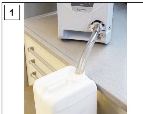
1. Отсоединить отводной шланг на выходе и под наклоном направить его в прочно установленную приемную емкость.
