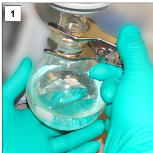
1. Разжать зажим для шлифа и снять стеклянную колбу.
