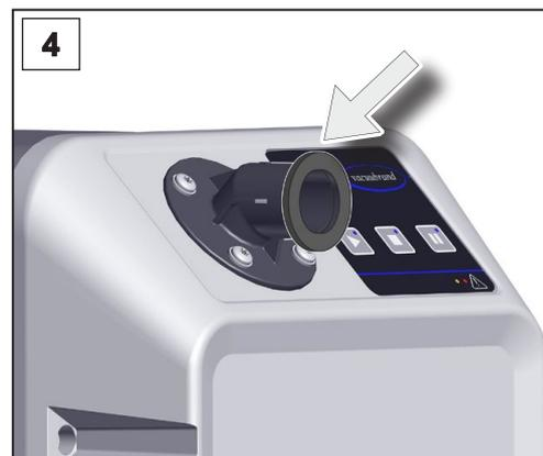
4. Прикрутить к впускному фланцу винты вместе с подкладными шайбами; звездообразная отвертка TX25.
