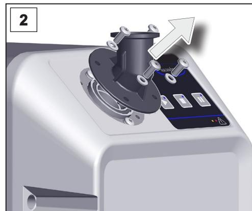
2. Снять впускной фланец. Проверить уплотнительное кольцо круглого сечения на наличие повреждений и прочность крепления.
