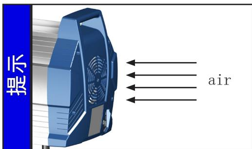
始终确保为风扇提供足够的送风。不能将泵放到软地基上（比如泡沫），这可能影响泵壳的空气循环，进而影响风扇的冷却效果！定期检查风扇是否脏污。对脏污的风扇格栅进行清洁，从而避免送风受限。
