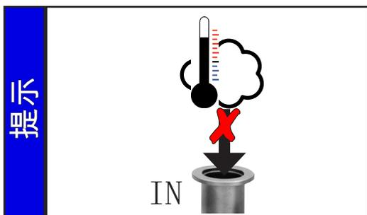
避免过多的热量输入（例如来自高温工艺气体）。允许的温度范围：参阅“技术参数 / 进气温度”。
