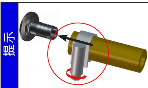
恰当锁固软管连接件，以防止意外松动（例如：使用软管箍）。
