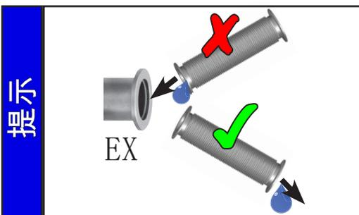
始终将排气管朝下铺设或采取其他措施，防止冷凝物从排气管回流至泵中。
