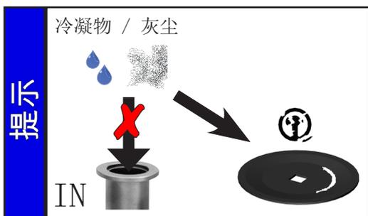
避免泵中出现冷凝，以及液体冲击和灰尘，因为持续泵送液体或灰尘会损坏膜片和阀。
