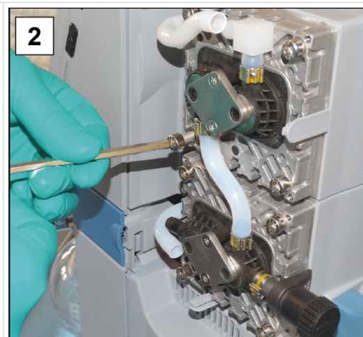
2. 将泵头对放于真空泵上，拧入螺栓；5号内六角扳手。
