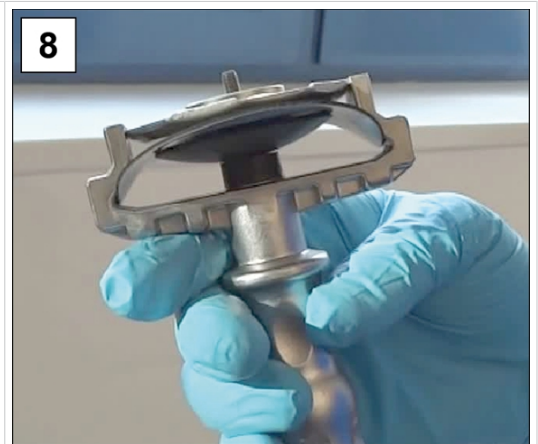
8. 将膜片组件固定在膜片扳手中。
