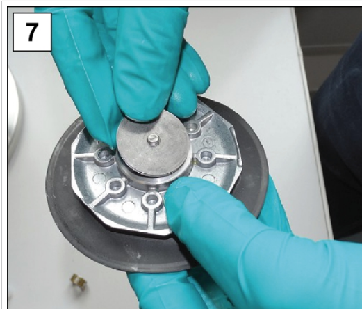
7. 将所有间隔垫片插到螺纹销上。
