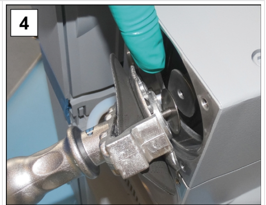
4. 将带有所有零件的膜片从真空泵中提出。 如果间隔垫片粘附在连杆上，则将其小心取出。
