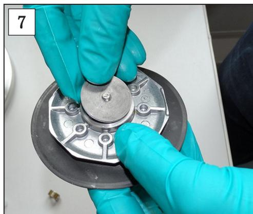
7. 将所有间隔垫片插到螺纹销上。
