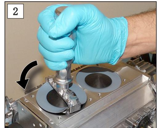
2. 将膜片扳手小心放到膜片支撑盘上，利用经固定的膜片扳手旋出组件。
