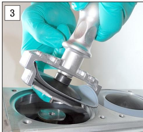
3. 将带有所有零件的膜片从真空泵中提出。
