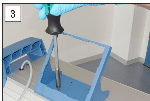
3. 用螺栓将固定基座与隔膜泵紧固在一起。
