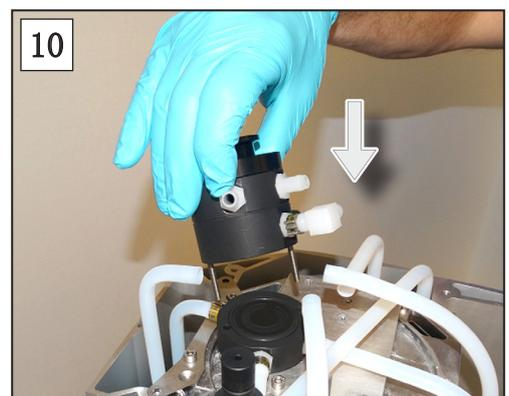
10. 安放带螺栓的吸气分配器并手动拧紧螺纹紧固件；2 号十字槽螺丝刀。
