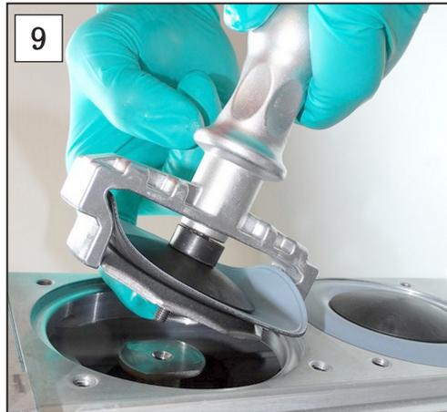
9. 制动住间隔垫片，将所有配件小心放在连杆螺栓上。
