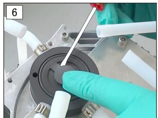
6. 小心移除用过的过压阀，例如使用一个坚固的塑料棒或一个细长的开槽螺丝刀。
