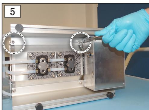
5. 旋入侧部衬板的螺纹紧固件；5号内六角扳手。
