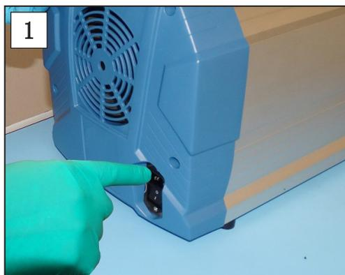
1. 关断 隔膜泵 并拔下电源插头。
