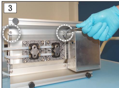
3. 旋出侧部衬板上的螺纹紧固件；5 号内六角扳手。
