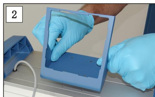
2. 将固定基座定位在隔膜泵上。
