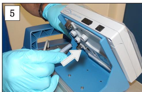
5. 将 VACUU • BUS 电缆插到电源接口中 - 控制器的背面。
