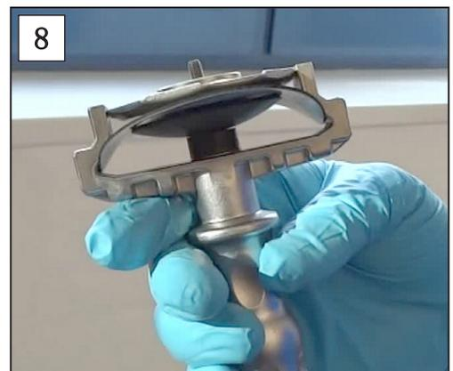
8. 将膜片组件固定在膜片扳手中。
