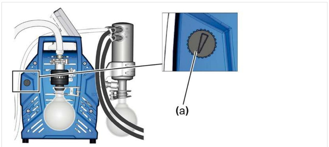
使用环境空气作为气体镇流时，不必连接到泵系统上；气体镇流阀 **(a)**；同时参见章节：→ 带气镇的操作 在一边 41
