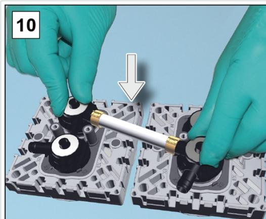
10. 用盘形弹簧将两个阀岛放于泵头上。
