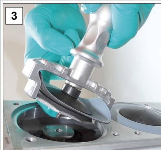
3. 将带有所有零件的膜片从真空泵中提出。如果间隔垫片粘附在连杆上，则将其小心取出。
