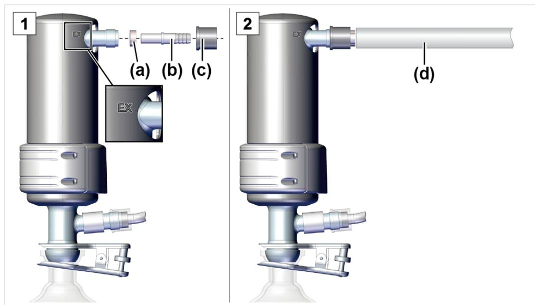
1. 按图所示连接橡胶密封圈(a)、软管轴(b)和锁紧螺母(c)并将其拧到接口上。
