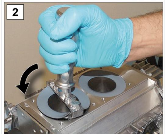
2. 小心地将膜片用扳手套到膜片垫圈上，然后用紧固的膜片用扳手拧出组件。
