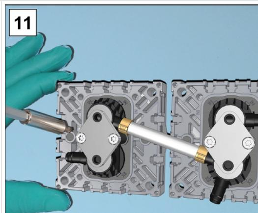
11. 将夹爪放在阀岛上，先用手拧紧螺纹接头，然后以 3 Nm 扭矩用扭矩扳手拧紧。
