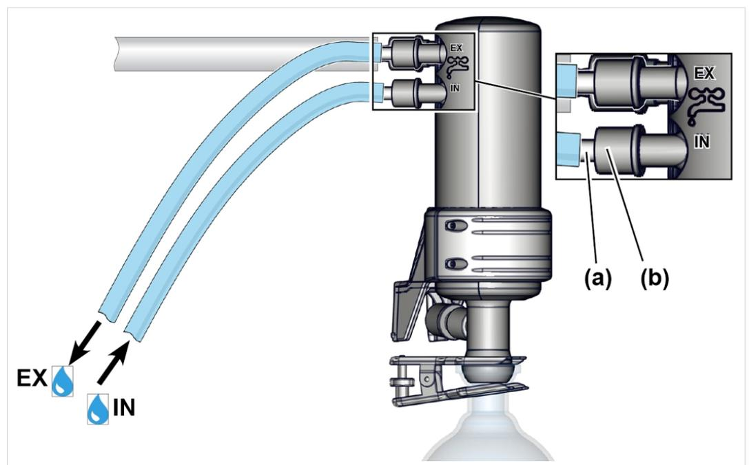
1. 如图所示，用锁紧螺母 **(b)** 将波纹软管 **(a)** 固定在冷凝器上。
