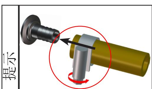
恰当锁固软管连接件，以防止意外松动（例如：使用软管箍）。
