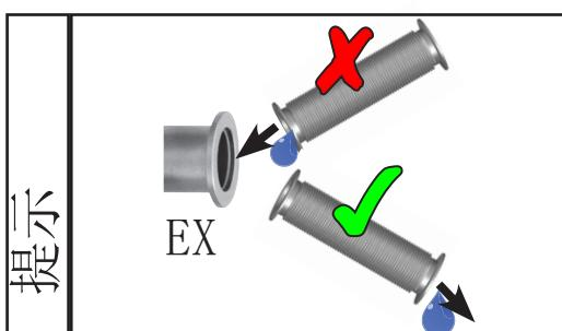
始终将排气管朝下铺设或采取其他措施, 防止冷凝物从排气管回流至泵中。
