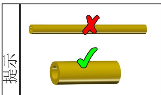
使用尽可能短且额定内径较大的真空连接管，以避免节流损失。
