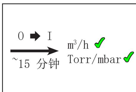
泵仅在工作温度下（约 15 分钟后）才达到指定的吸力和极限真空以及蒸汽耐受性 (MZ 1C) 的规定数值。
