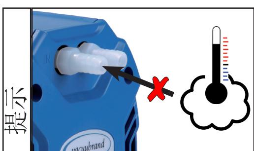
避免过多的热量输入（例如来自高温工艺气体）。允许的温度范围：参阅“技术参数 / 进气温度”。
