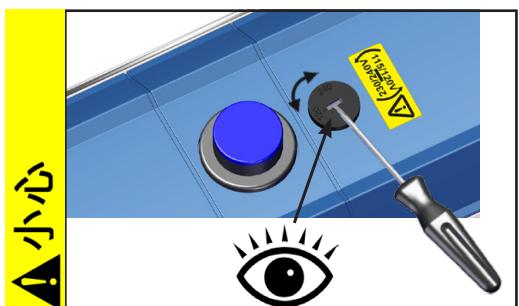
设置电压选择开关的电压范围:
