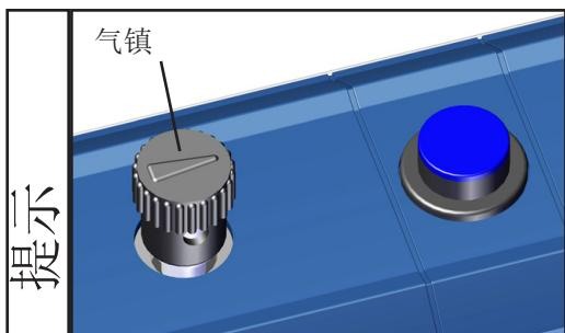
输送可冷凝的蒸汽时，使用气镇运行泵 (MZ 1C)，以减少泵送物质（水蒸气、溶剂……）在泵中的冷凝。
