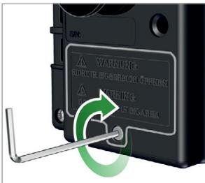
4. 在测量仪上正确安放电池仓盖连同螺钉，并用手拧紧螺钉。拧紧时请注意 0.4 Nm 的最大扭矩。
