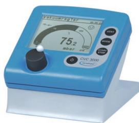
Le régulateur avec pied peut être directement installé et branché sur la surface de travail, p. ex. sur une pailleuse.
