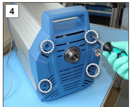
4. Révissez les 4 vis de la partie avant du boîtier à l'aide d'une clé Allen de taille 4.
