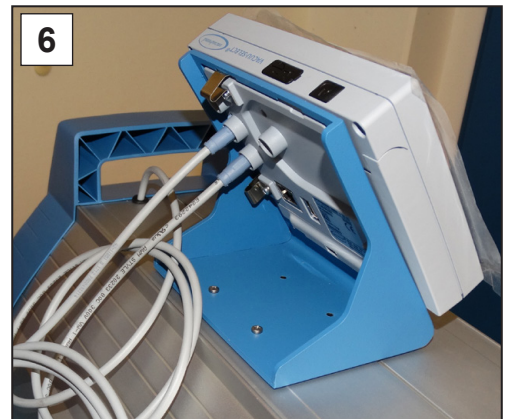
6. Fixez le régulateur sur la pompe à membrane et raccordez l'ensemble des câbles.
