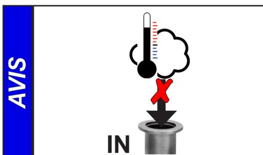
Évitez un apport de chaleur importante (par exemple à cause des gaz de processus chauds). Températures maximales admissibles: cf «Températures des gaz aspirés»
