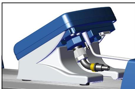
Le régulateur CVC 3000 est équipé d'un capteur de pression en céramique qui enregistre la pression actuelle selon le principe de mesure capacitif, indépendant de la nature du gaz employé et dépendant du vide, c.-à-d. absolument.
