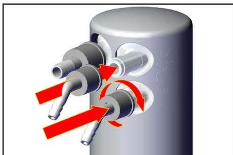
➔ Assemblez des embouts pour l'entrée et la sortie du réfrigérant (embouts 6-8 mm) au condenseur de vapeurs.
