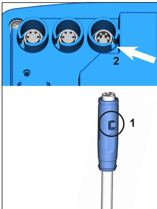
Dépendant de la version technique les câbles VACUU-BUS sont équipés avec un guide.
