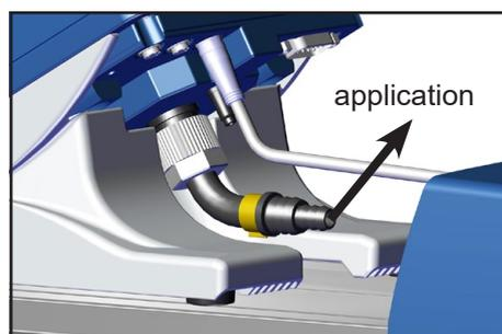
Connectez le raccord de mesure du régulateur (à l'arrière du CVC 3000; embout DN 6/10 mm ou raccord à visser pour tube en PTFE 10/8 mm) à l'application. Utilisez un tuyau à section suffisante.
