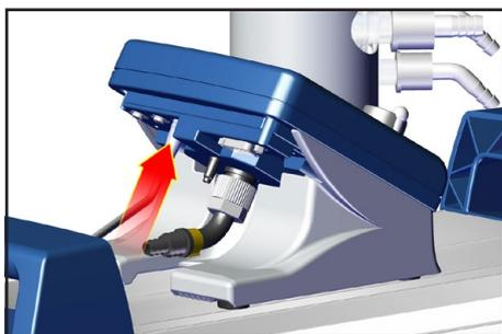
Raccorder le régulateur CVC 3000 avec le câble VACUU•BUS de la pompe NT VARIO.
