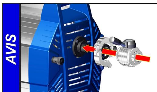
Il est recommandé d'installer une vanne à l'aspiration pour le préchauffage et pour faire fonctionner la pompe sur elle-même après le pompage.
