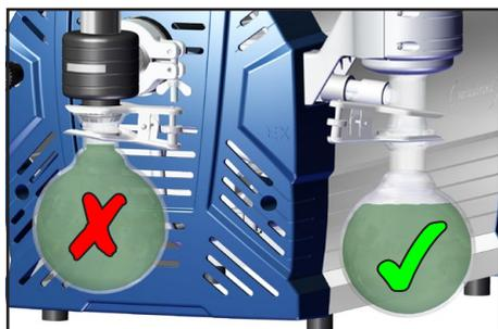
En cas de **formation de condensat**: Contrôlez régulièrement le niveau de condensat dans des ballons collecteur et vidangez-les à temps. Evitez un débordement des ballons collecteur. Si nécessaire, installez un capteur de niveau de remplissage (cf «Accessoires»).
