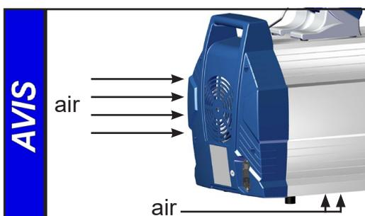
Veillez à une amenée d'air adéquate aux ventilateurs. Ne pas mettre la pompe sur une surface molle (p.ex. produits alvéolaires), ça peut bloquer ou gêner l'amenée d'air aux ventilateurs! Contrôlez régulièrement les grilles de ventilateur et nettoyez des grilles encrassées évitant une restriction d'amenée d'air.
