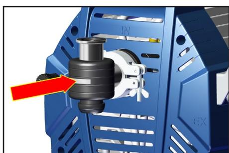
Le séparateur à l'aspiration empêche l'entrée des particules solides ou liquides dans la pompe endommageant clapets et membranes.
