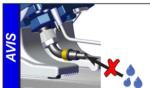
S'il y a des condensats ou des dépôts au capteur de pression, la mesure sera moins précise.
