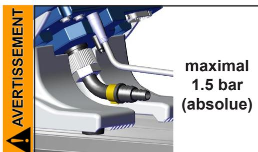
☞ Pression admissible au capteur de pression: 1.5 bar (absolue) au maximum.
