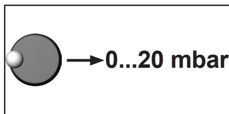
Au lieu d'ajuster par rapport à une pression au-dessous de 0.1 mbar, l'ajustement peut être réalisé à une pression de référence se trouvant dans la gamme de 0 .... 20 mbar. Pompez jusqu'à une pression dans la gamme de 0 .... 20 mbar.
