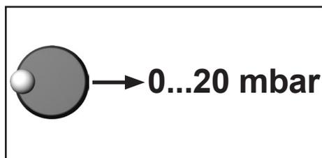
Au lieu d'ajuster par rapport à une pression au-dessous de 0.1 mbar, l'ajustement peut être réalisé à une pression de référence se trouvant dans la gamme de 0 .... 20 mbar.
