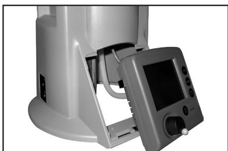
A l'arrière du régulateur se trouvent des prises femelles pour raccorder des composants (vanne de fluide réfrigérant, capteur de pression externe, vanne d'aération externe), un raccord d'aération et l'interface série RS 232C.
