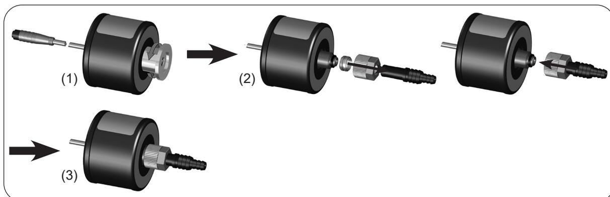
**Montage des PTFE-Rohr-Anschlusses** (für PTFE-Rohr ID 8 mm, OD 10 mm):
