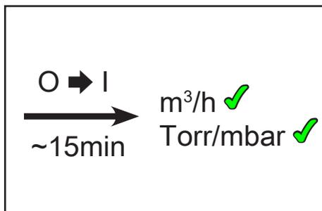
Die Pumpe erreicht die angegebenen Werte für Saugleistung und Endvakuum erst bei Betriebstemperatur (nach ca. 15 min.).
