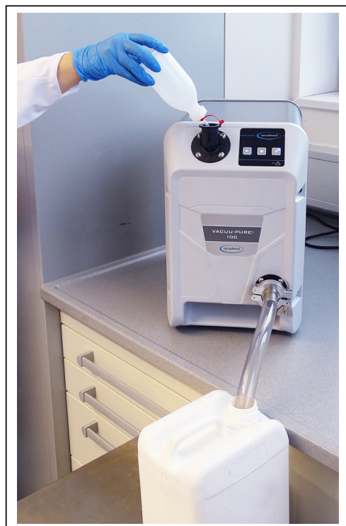
Beispielhafte Anordnung zum Spülen der Vakuumpumpe
