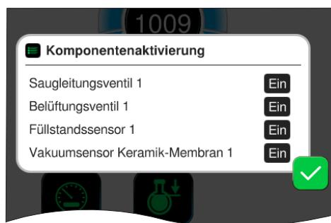
Mit der **Komponentenaktivierung** lässt sich ein angeschlossener Füllstandssensor aktivieren oder deaktivieren, d. h. der Füllstandssensor kann angeschlossen bleiben, wird aber für den laufenden Prozess nach Bedarf am Controller ein- oder ausgeschaltet.
