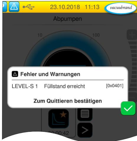
Das Auslösen des Füllstandssensors führt nicht sofort zu einem Prozessstopp. Bis zum Erreichen der am Controller einstellbaren **Verzögerungszeit** läuft der Prozess weiter.
