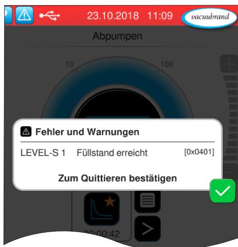
Die Verzögerungszeit ist abgelaufen. Der laufende Prozess wird gestoppt. Es besteht die Gefahr, dass der Auffangkolben überläuft.
