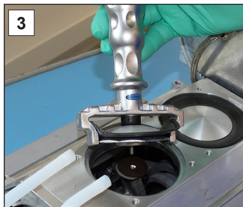
3. Heben Sie die Membran mit allen Teilen aus der Vakuumpumpe.
