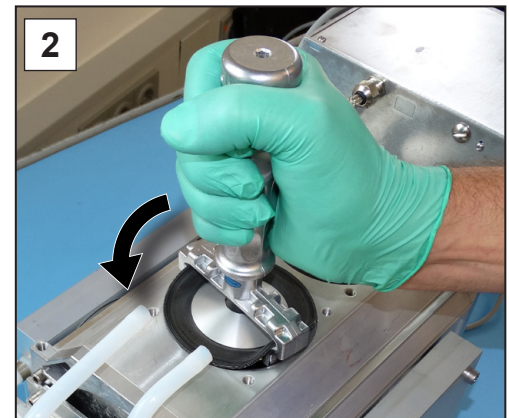
2. Setzen Sie vorsichtig den Membranschlüssel an der Membranstützscheibe an und drehen Sie mit dem fixierten Membranschlüssel die Baugruppe heraus.
