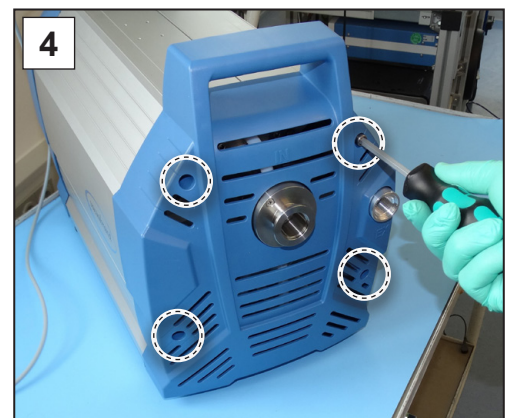
4. Drehen Sie die 4 Schrauben vom vorderen Gehäuseteil ein; Innensechskantschlüssel Gr. 4.
