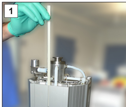
1. Schieben Sie die Leiste in die Nut zwischen den Seitenverkleidungen ein.
