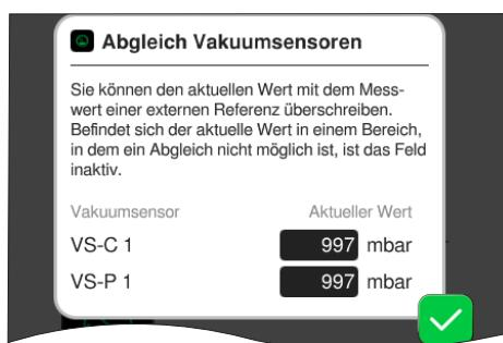
Bedienfeld für den Abgleich angegeschlossener VakuumSENSOREN bei Umgebungsdruck und unter Vakuum.
