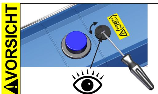
**Spannungsbereich am Spannungswahlschalter einstellen:**
