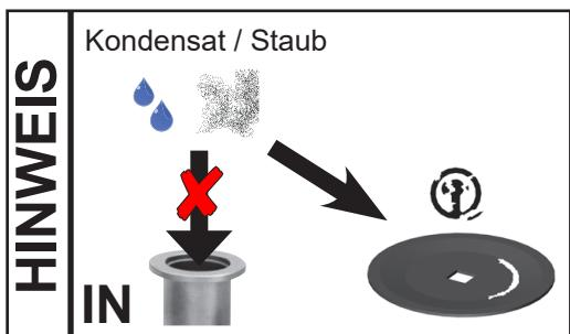
Kondensation in der Pumpe, sowie Flüssigkeitsschläge und Staub vermeiden, da eine Dauerförderung von Flüssigkeiten oder Staub Membrane und Ventile schädigt.
