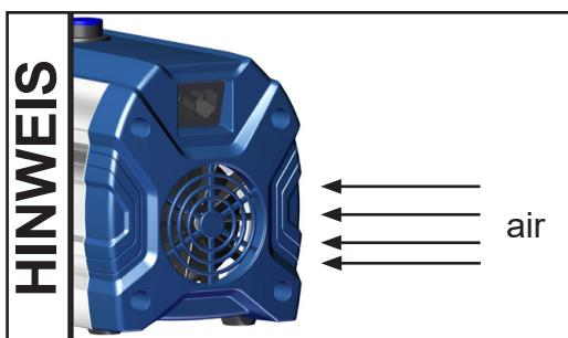
Stets eine ausreichende Luftzufuhr zum Lüfter sicherstellen. Den Lüfter regelmäßig auf Verschmutzung überprüfen. Verschmutztes Lüftergitter reinigen, um eine Einschränkung der Luftzufuhr zu vermeiden.
