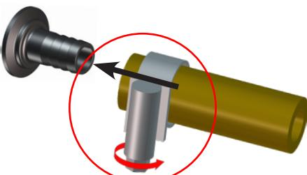
Schlauchverbindungen geeignet gegen unbeabsichtigtes Lösen sichern (z.B.: Schlauchsclappen verwenden).
