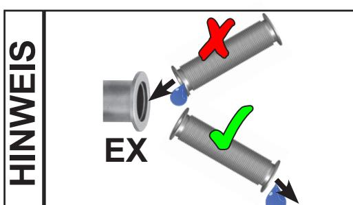
Auspuffleitungen stets fallend verlegen oder andere Maßnahmen ergreifen, um Kondensatrückfluss aus der Auspuffleitung in die Pumpe zu verhindern.
