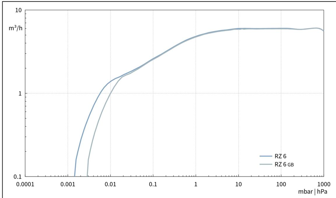
Courbe de pompage à 50 Hz (réservoir 10 l)
