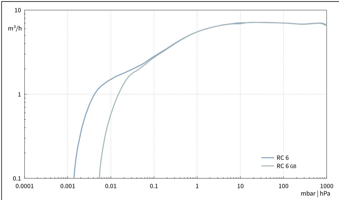
Courbe de pompage à 60 Hz (réservoir 10 l)
