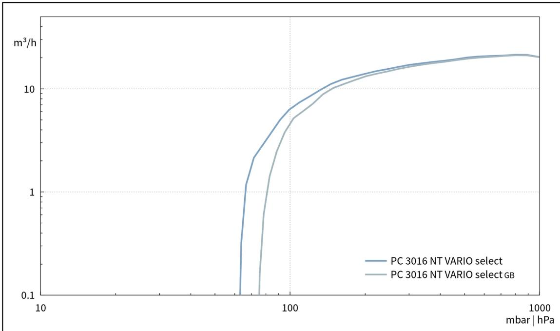
Courbe de pompage à 60 Hz (réservoir 100l)
