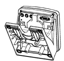
Für Einbau, Fuß entfernen und Einbausatz 636593, bestehend aus drei Federclipse plus Schrauben 3x10, montieren. For mounting,remove stand foot and assemble installation kit 636593, consisting of 3 clips and 3 screws 3x10.
