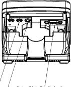
Anschluß VACUU·BUS VACUU·BUS connection
