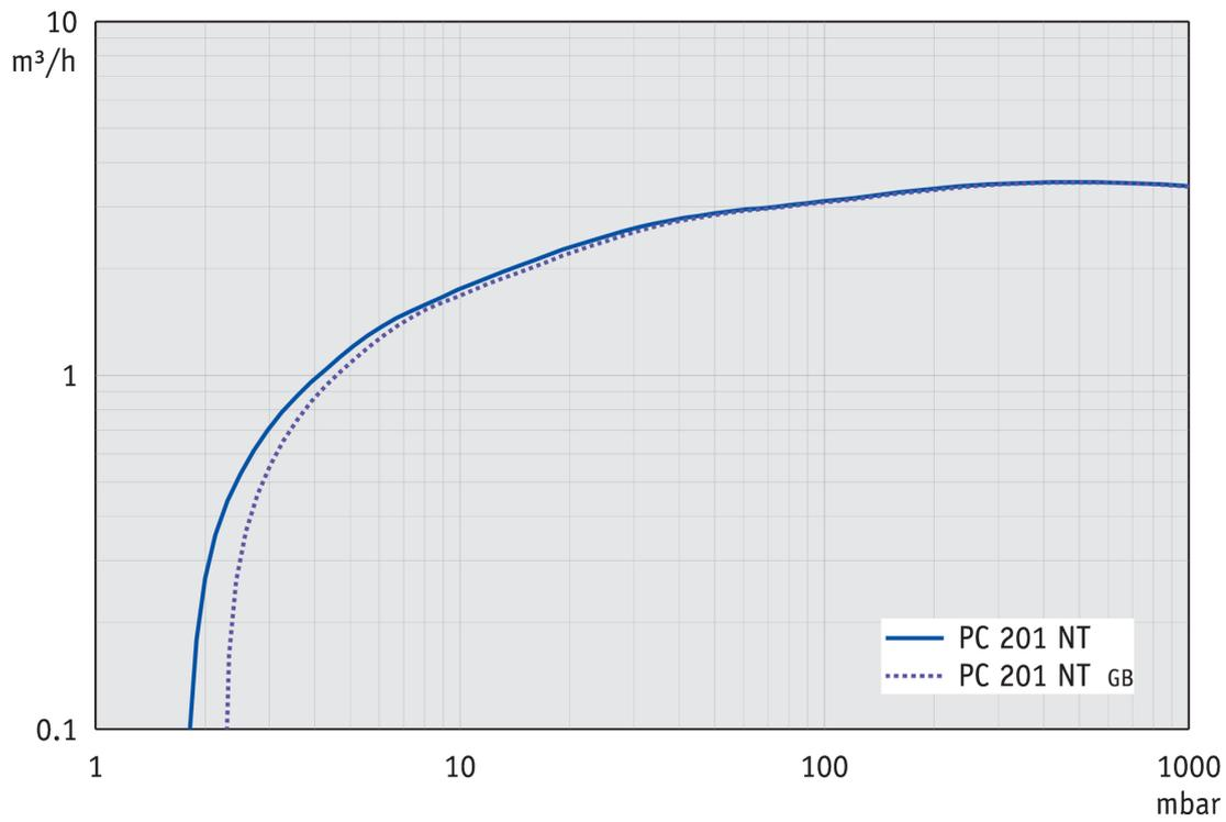
Abpumpkurve bei 60 Hz (10 l Behälter)
