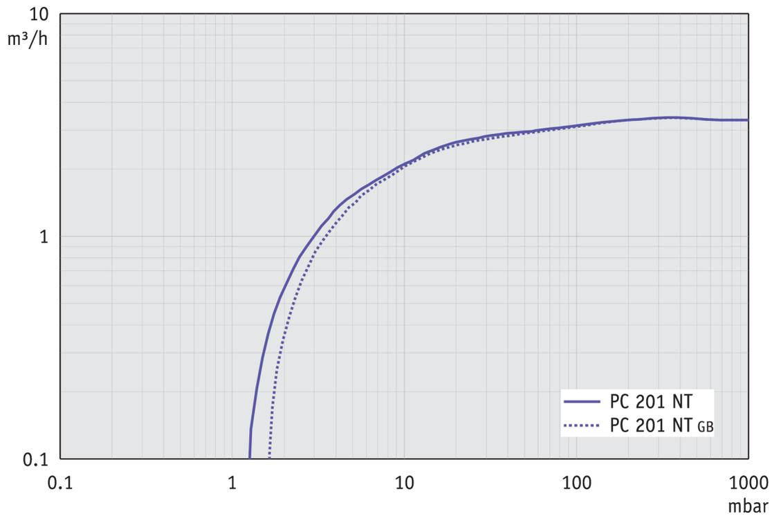
Abpumpkurve bei 50 Hz (10 l Behälter)
