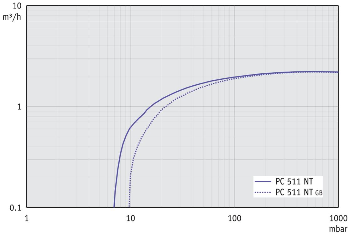
Abpumpkurve bei 60 Hz (10 l Behälter)
