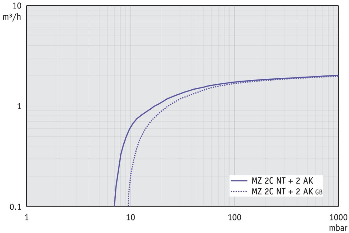
Abpumpkurve bei 50 Hz (10 l Behälter)
