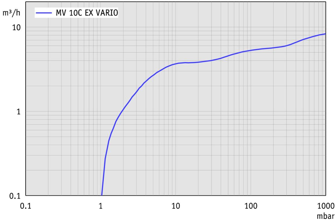
Abpumpkurve bei 50 Hz (100 l Behälter)
