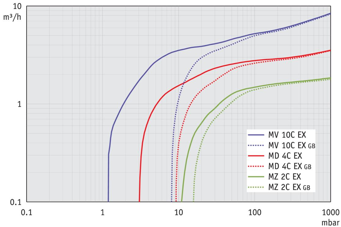
Abpumpkurve bei 50 Hz (100 l Behälter)
