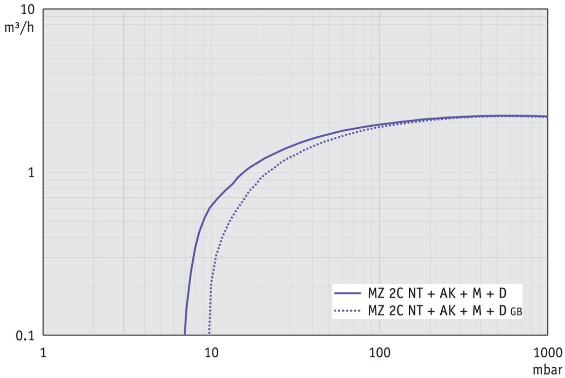
Abpumpkurve bei 60 Hz (10 l Behälter)
