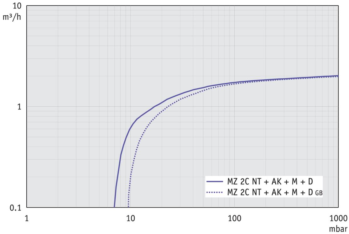
Abpumpkurve bei 50 Hz (10 l Behälter)
