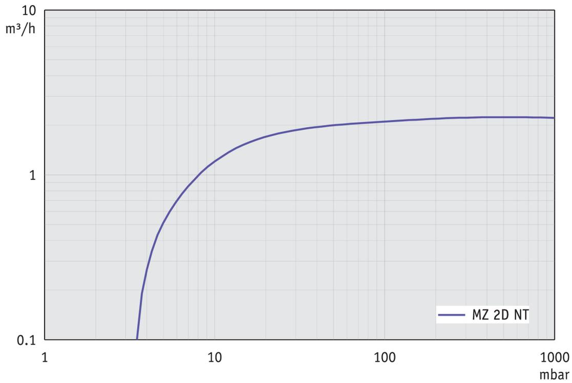
Abpumpkurve bei 50 Hz (10 l Behälter)
