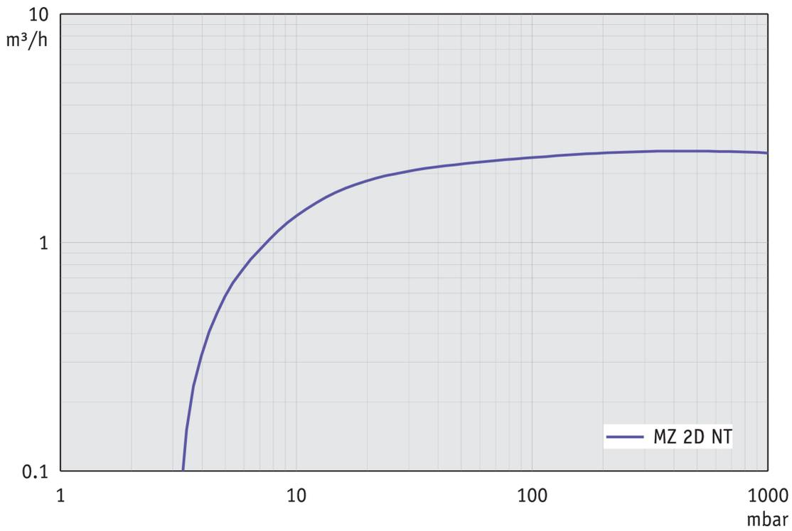
Abpumpkurve bei 60 Hz (10 l Behälter)
