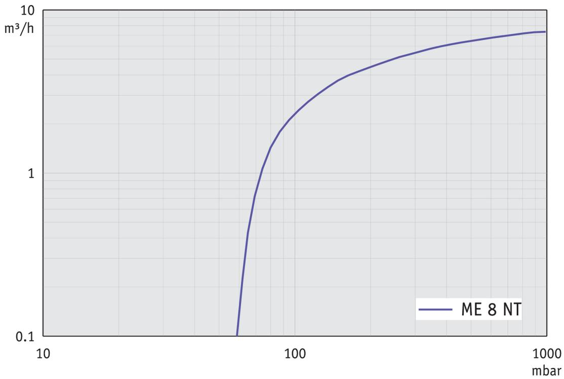
Abpumpkurve bei 50 Hz (100 l Behälter)
