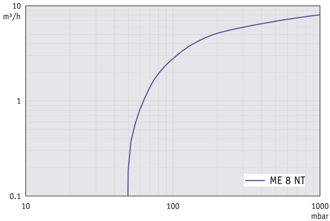
Abpumpkurve bei 60 Hz (100 l Behälter)
