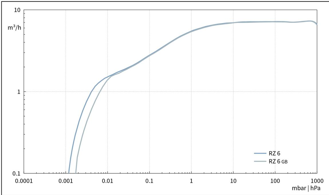
Abpumpkurve bei 60 Hz (10 l Behälter)
