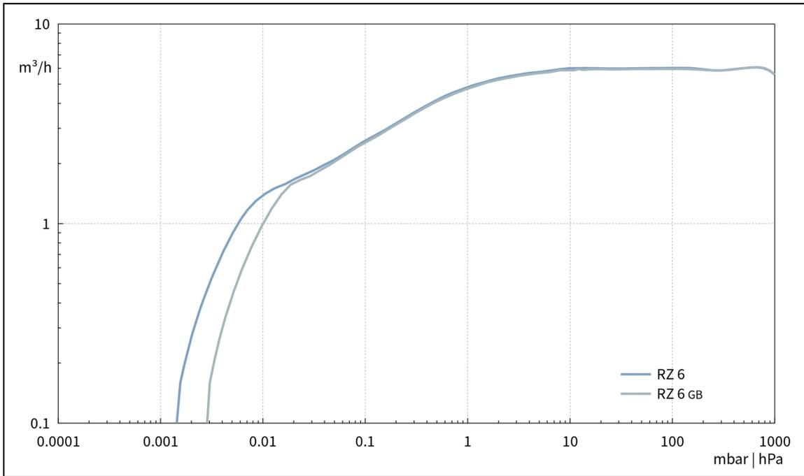
Abpumpkurve bei 50 Hz (10 l Behälter)
