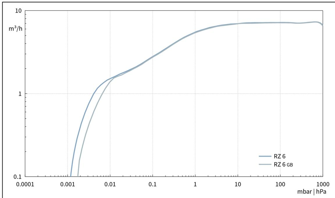
Abpumpkurve bei 60 Hz (10 l Behälter)
