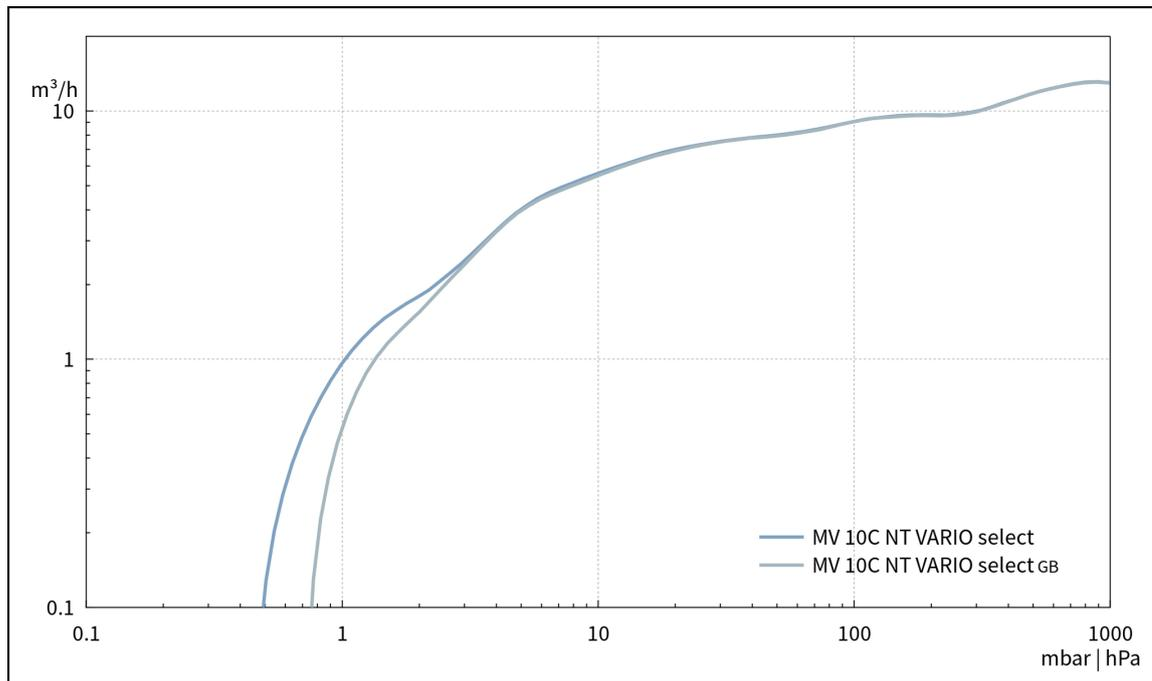
Abpumpkurve bei 60 Hz (100 l Behälter)
