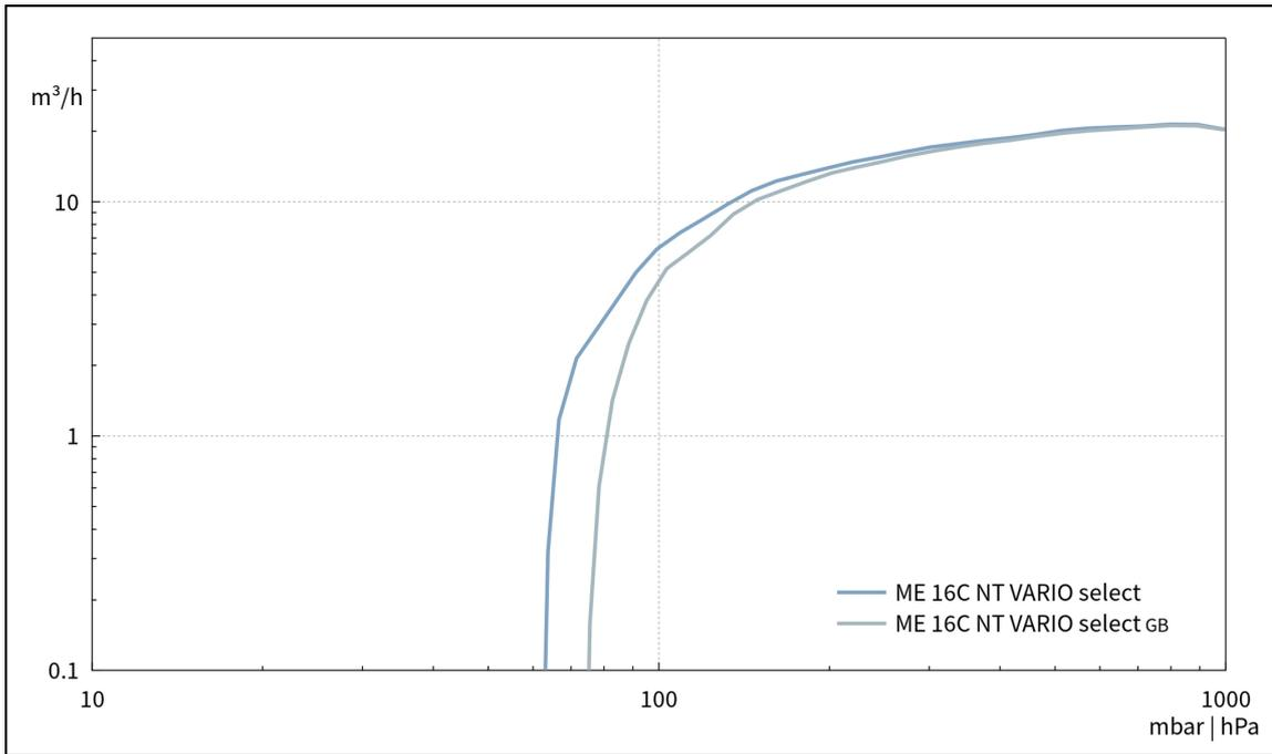
Abpumpkurve bei 60 Hz (100 l Behälter)
