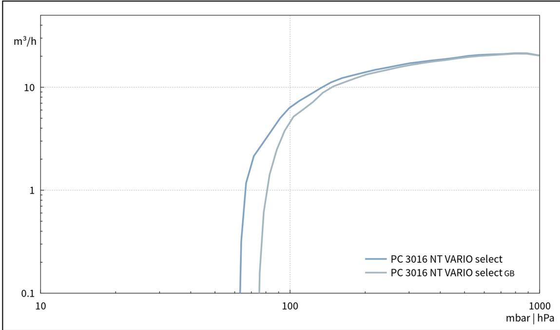
Abpumpkurve bei 60 Hz (100 l Behälter)
